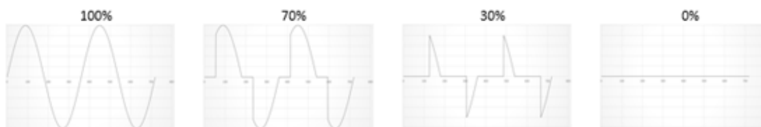
Rysunek 3 - modulowanie napięcia zasilania w zależności od zapotrzebowania na moc grzewczą
